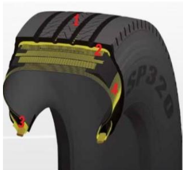
Figura C. Composto de borracha na banda de rodagem (1), Banda de rodagem com camada dupla (2), Talão reforçado (3), Carcaça mais robusta (4).
